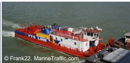
Type 2 pusher: 2 x 895 kW/1800rpm
